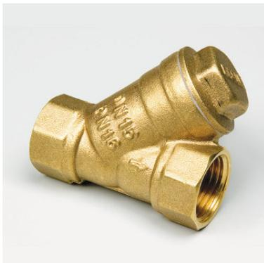
Фильтр грубой очистки предназначен для предварительной очистки питьевой воды или воды в системах горячего водоснабжения протекающей по трубопроводу при температуре до 90 °С и давлении не более 1,6 МПа (16 кгс/см<sup>2</sup>). Рекомендуется для совместной установки со счетчиками воды. При установке фильтра стрелка на корпусе должна совпадать с направлением потока воды.
