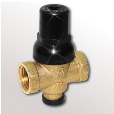
Регуляторы давления предназначены для автоматического поддержания давления воды на выходе при изменении входного давления и используются в системах горячего и холодного водоснабжения, включая питьевое, коммунальное и промышленное. Основная сфера применения - многоквартирные жилые дома.
